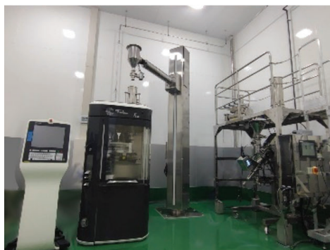
直打システム (左：打錠機FE35、右：SCTS-MG200)
